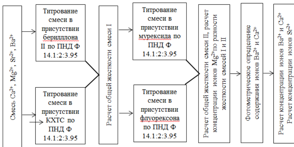
Рис. Алгоритм определения содержания ионов \text{Ca}^{2+} , \text{Mg}^{2+} , \text{Ba}^{2+} и \text{Sr}^{2+} при совместном присутствии
